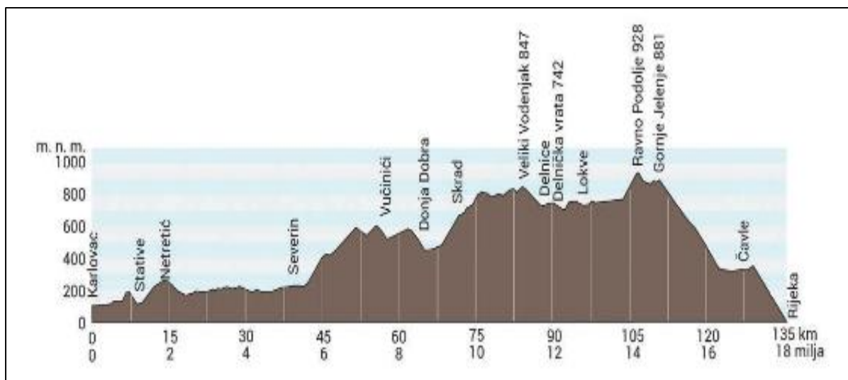
Slika 13: Uzdužni hipsometrijski profil Lujzinske ceste od Karlovca do Rijeke
