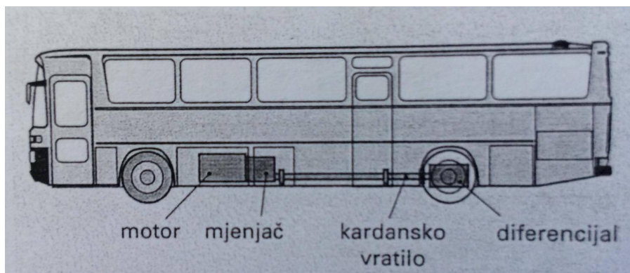
Slika 5. Motor ispod poda
