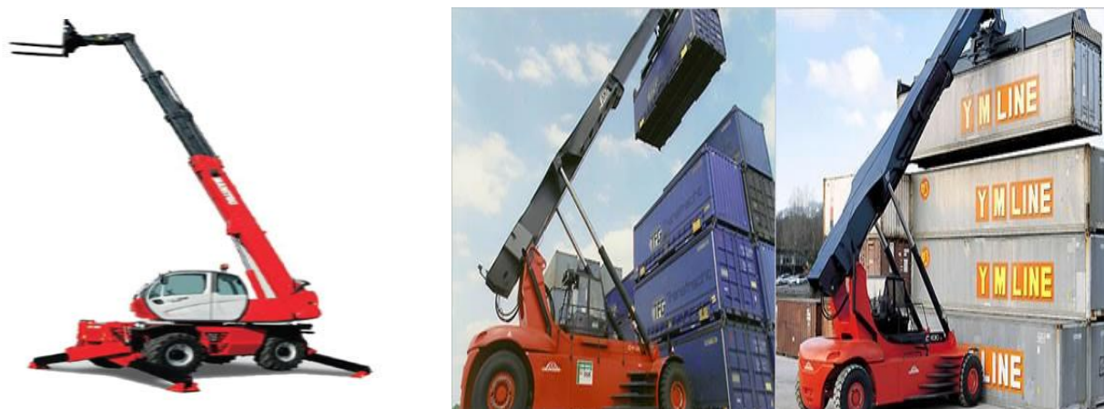
Slika 11. Teleskopski i portalni viličari
