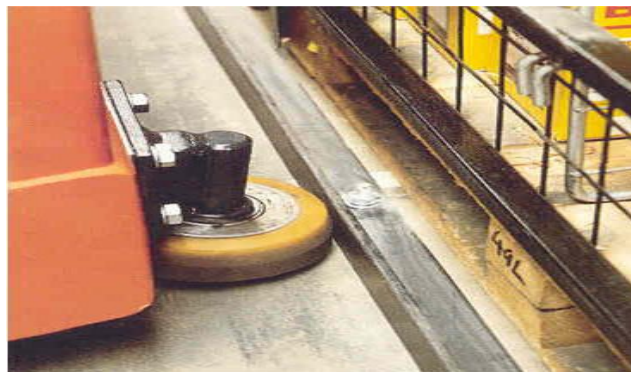
Slika 15. Valjak pomoću kojih su vođeni viličari
