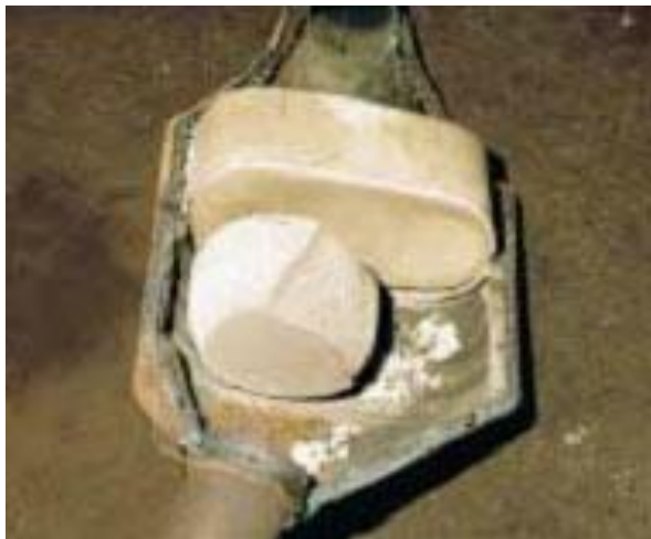
Slika 10. Fizičko oštećenje katalizatora
