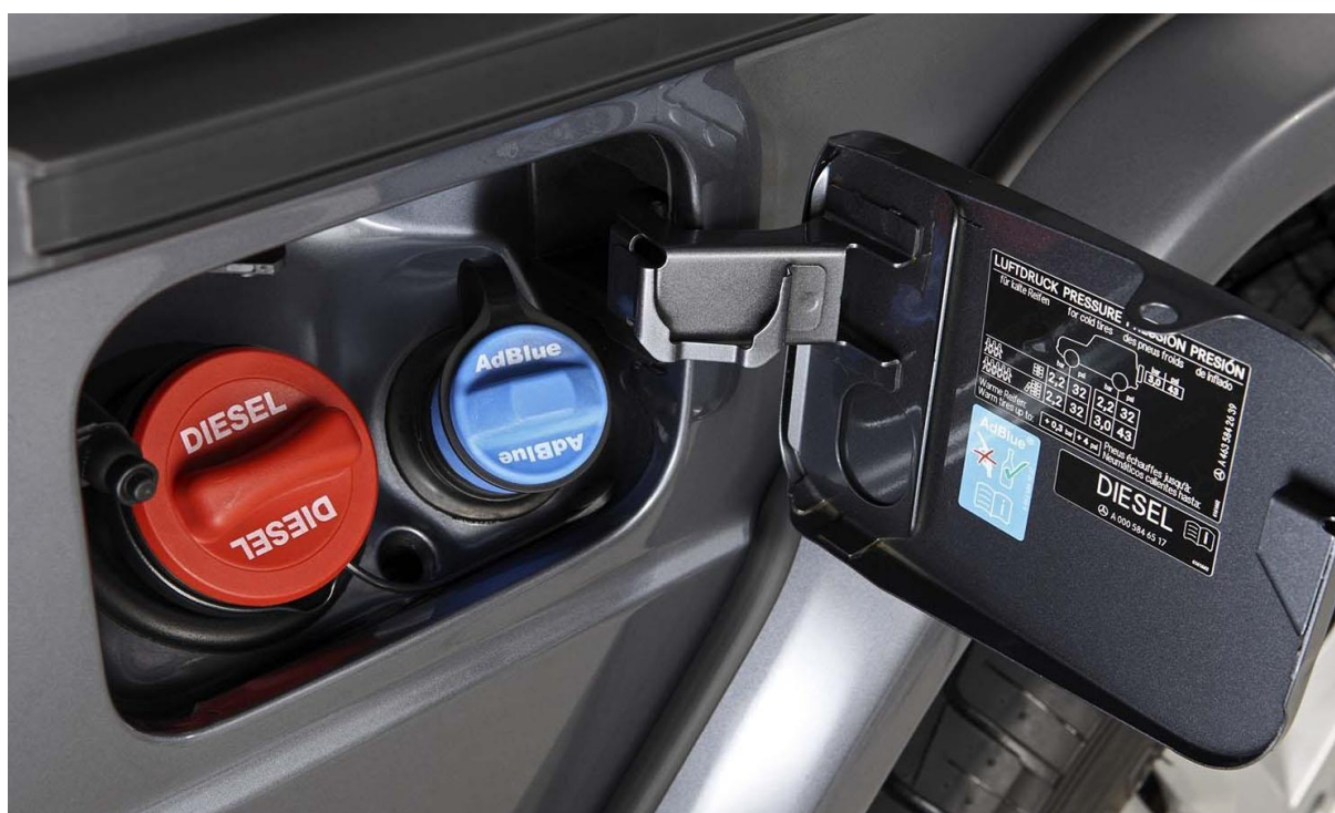
Slika 16. Prikaz izvedbe AdBlue spremnika kod novih automobila
