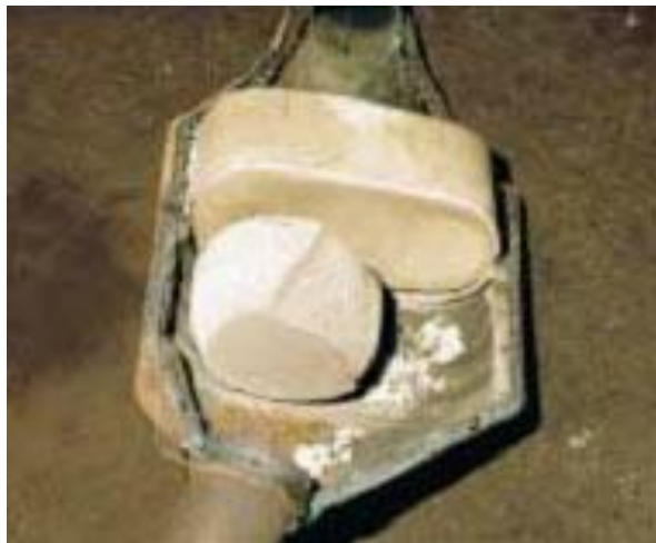
Slika 10. Fizičko oštećenje katalizatora
