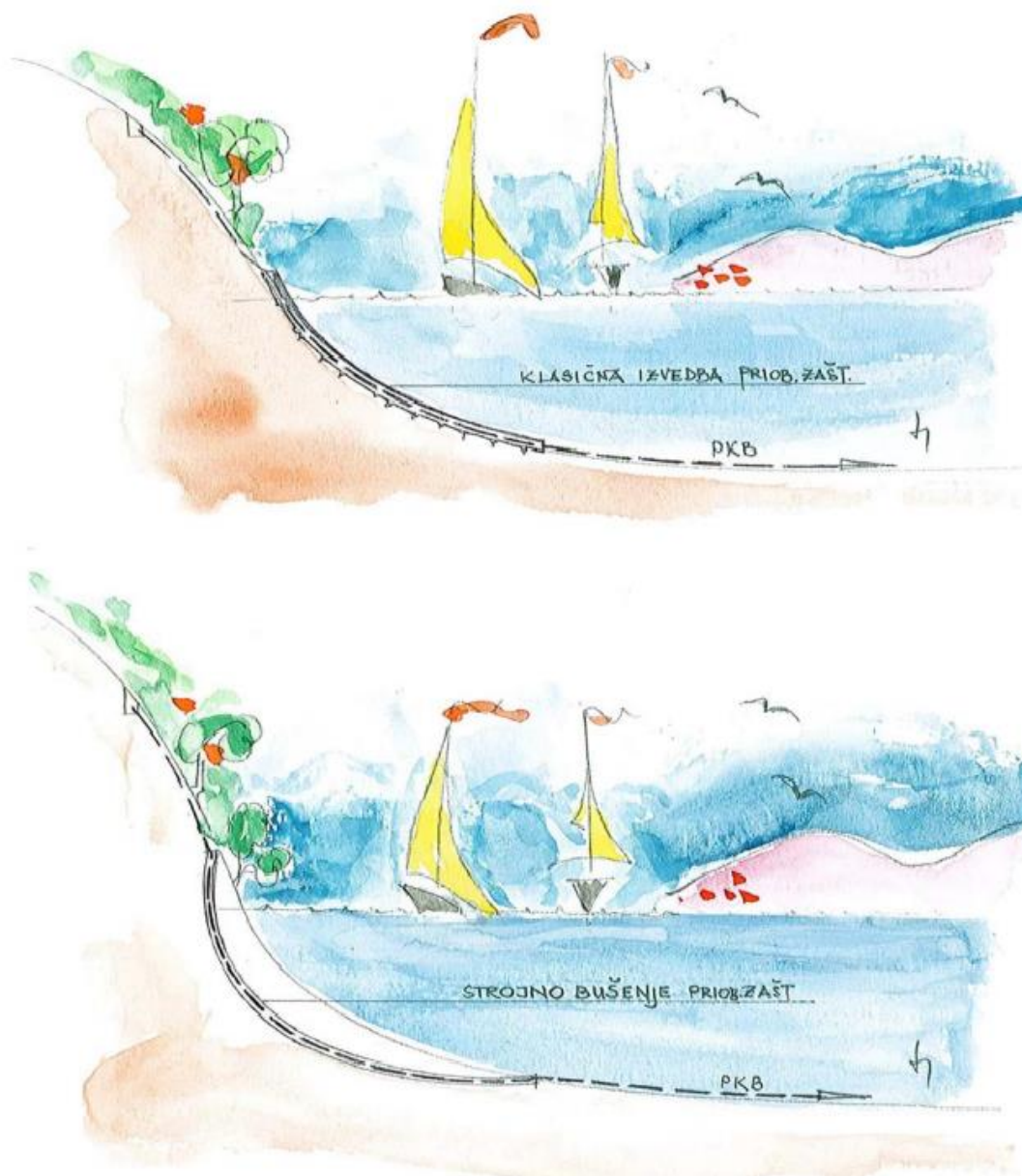
Slika 18. Klasična i strojna izvedba priobalne zaštite
