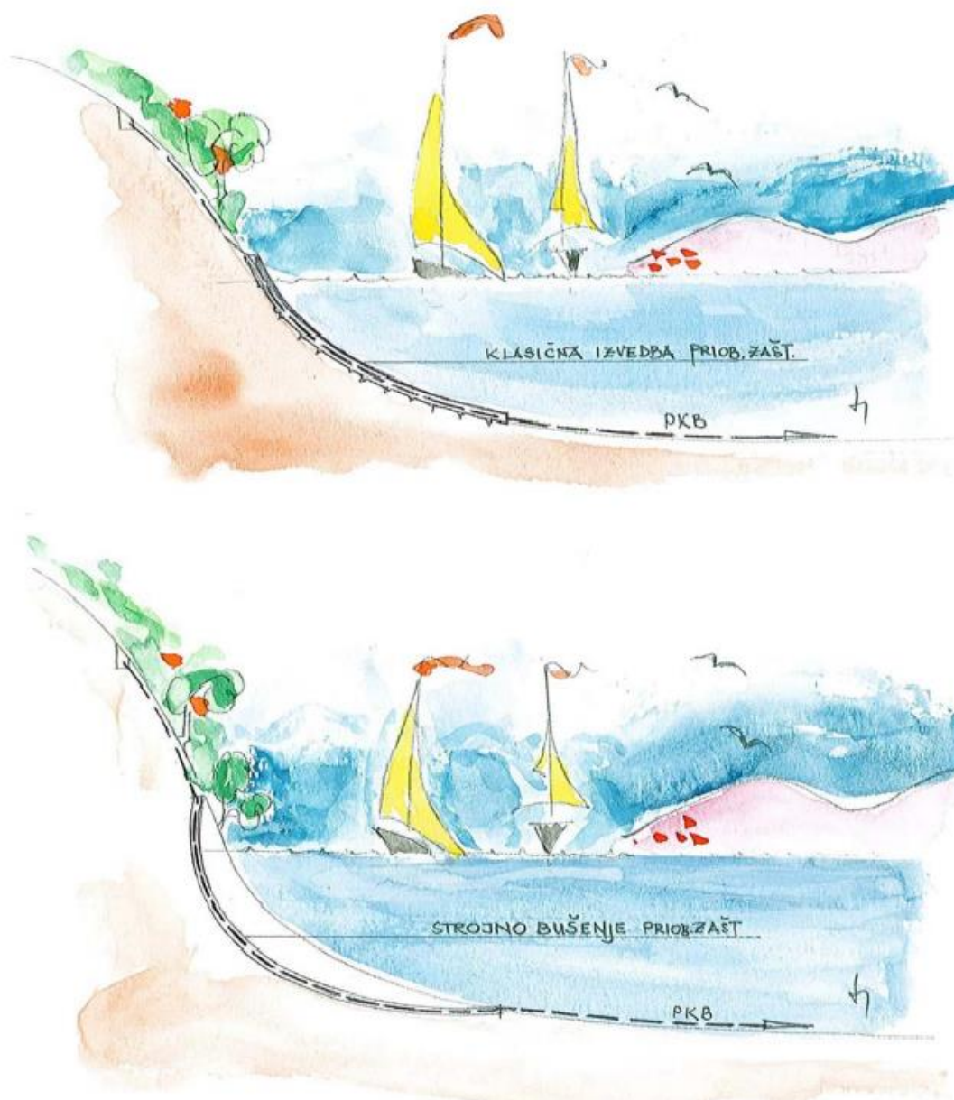
Slika 18. Klasična i strojna izvedba priobalne zaštite
