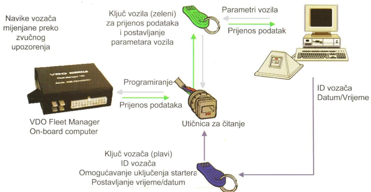
Slika 3. Osnovna konfiguracija za Fleet management
