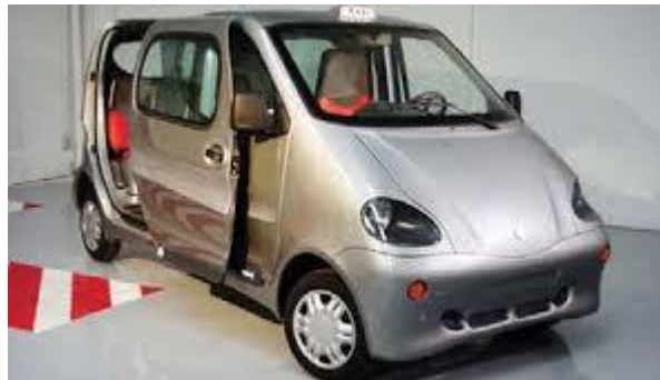
Slika 14. Hybridno vozilo CityCat na pogon komprimiranim zrakom
