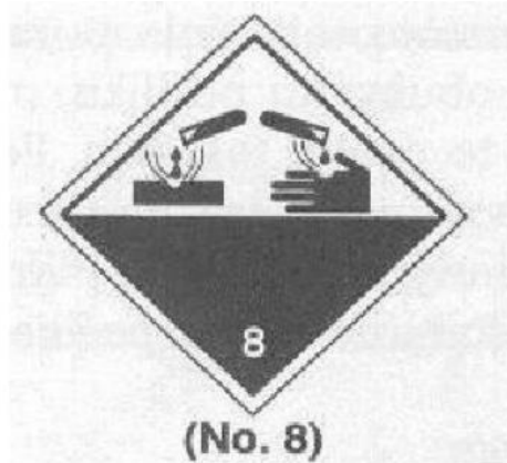
Slika 9. Korozivne tvari (kemikalije)
