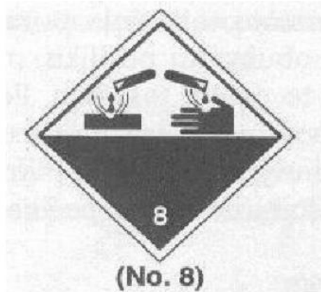
Slika 9. Korozivne tvari (kemikalije)
