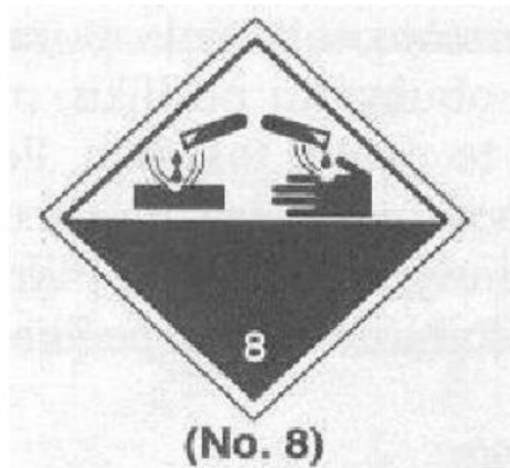
Slika 9. Korozivne tvari (kemikalije)
