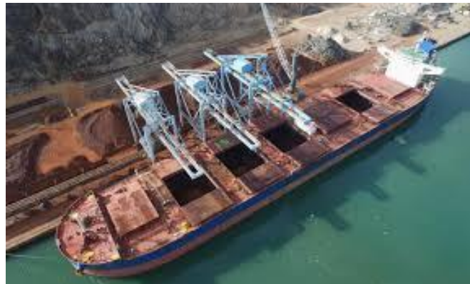
Slika 7. Prikaz utovarivanja sipkog tereta u brod pomoću trakastih transportera
