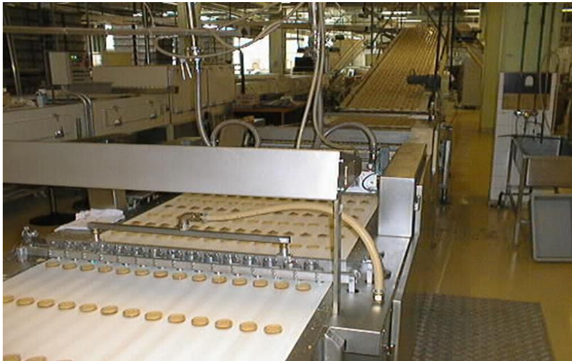
Slika 28. Trakasti transporter s čeličnom trakom
