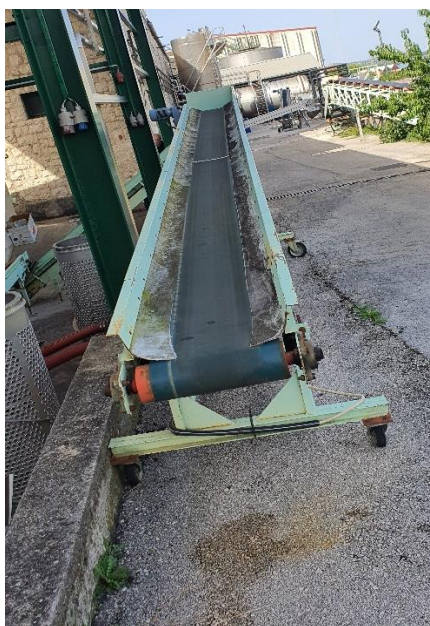
Slika 26. Kosi mobilni traksti transporter s ravom gumenom trakom
