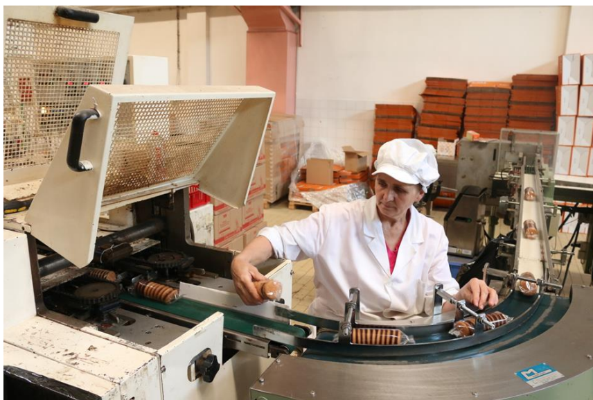
Slika 30. Trakasti transporter na mašini za pakiranje
