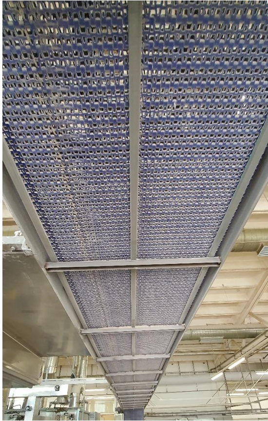
Slika 36. Ovješeni trakasti transporter s plastičnom trakom
