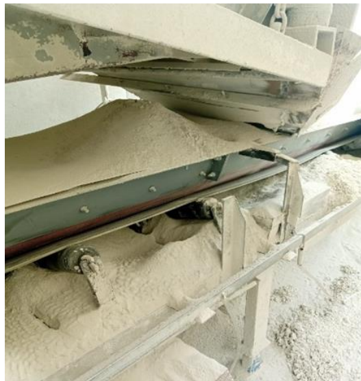
Slika 23. Trakasti transporter koji prenosi vapno
