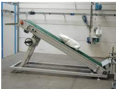
Slika 4. Trakasti transporter pod nagibom
