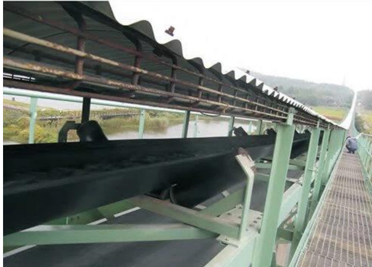
Slika 6. Transporter velike udaljenosti s natkrivenom trakom
