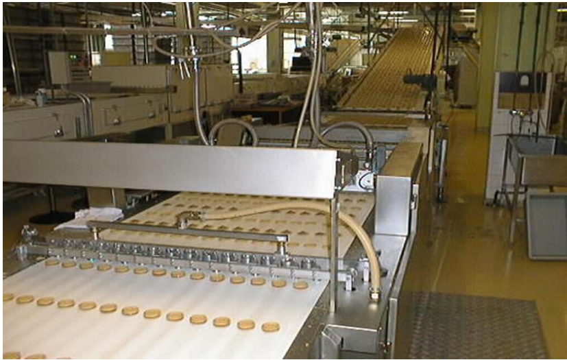
Slika 28. Trakasti transporter s čeličnom trakom
