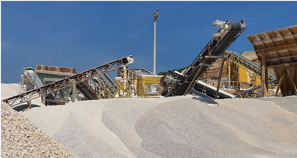
Slika 18. Različite vrste trakastih transportera u kamenolomu Veprštak
