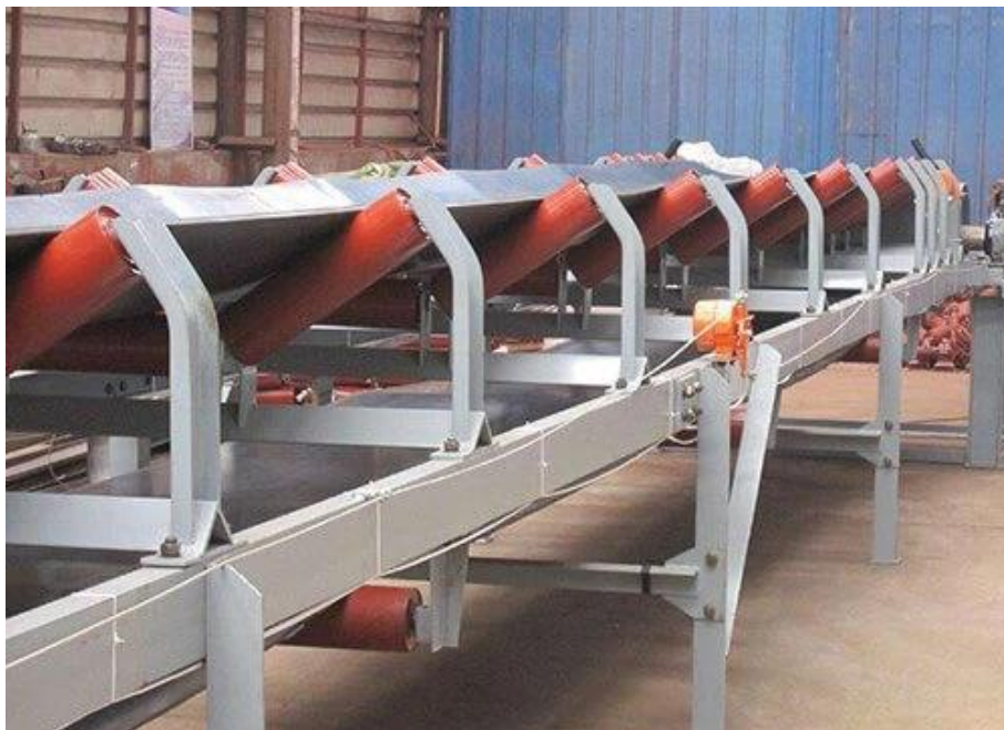
Slika 9. Valjci za usmjerivanje i nošenje trake
