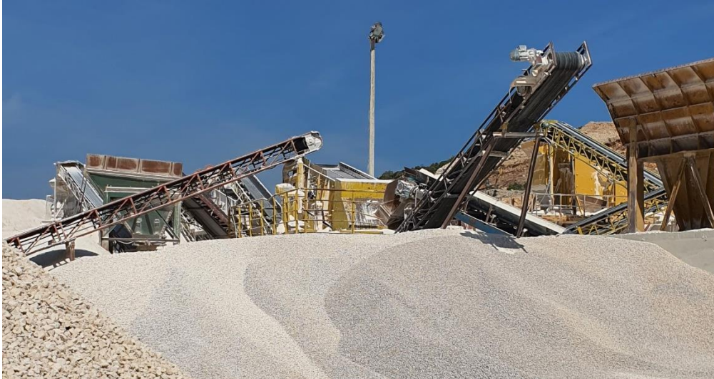
Slika 18. Različite vrste trakastih transportera u kamenolomu Veprštak
