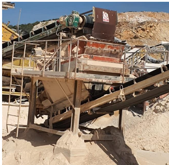
Slika 17. Drobilica za kamen s dva trakasta transportera s gumenom trakom
