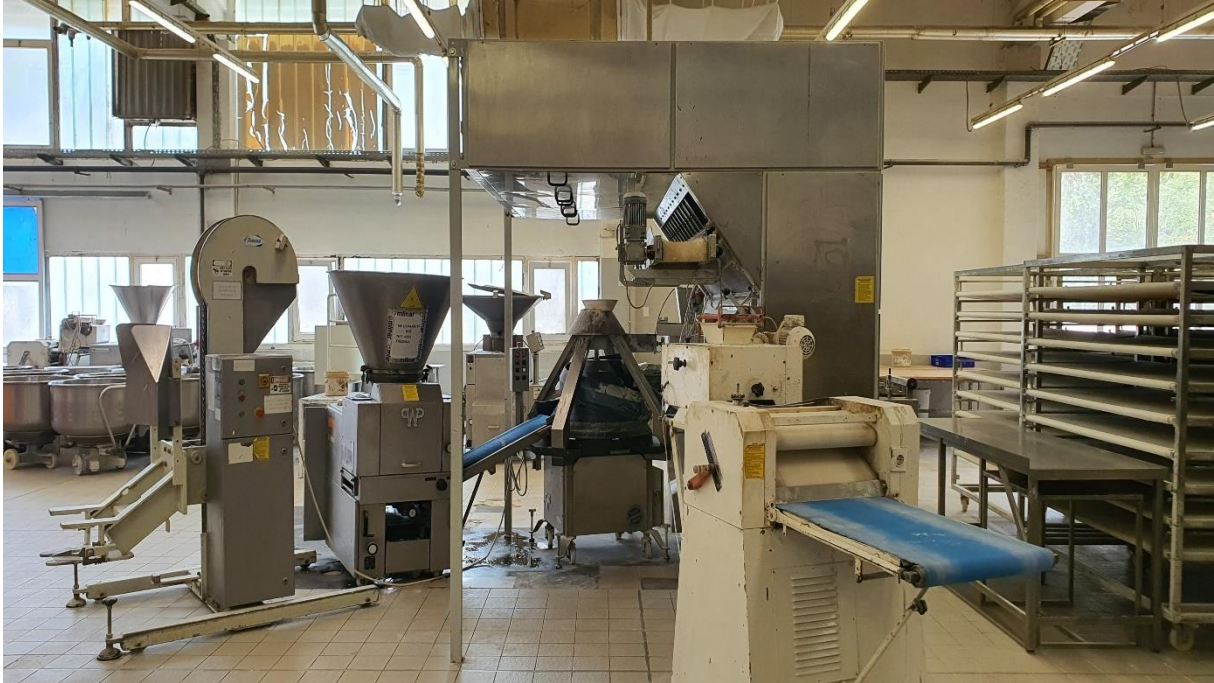
Slika 34. Strojevi za obradu tijesta
