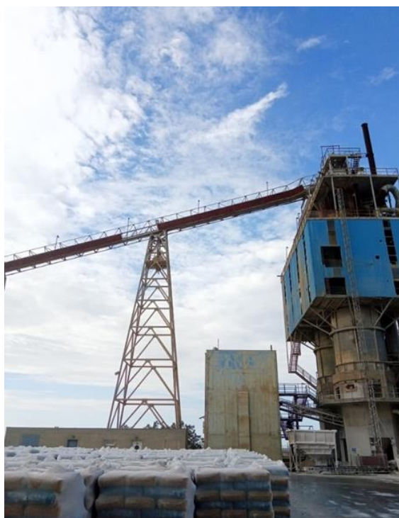
Slika 25. Transportna traka kojom usitnjena mineralna sirovina ide u Visoku peć
