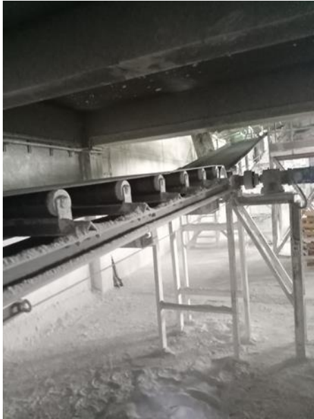
Slika 27. Trakasti transporter sa sintetičkom trakom (lijevo), valjkasti transporter (desno)
