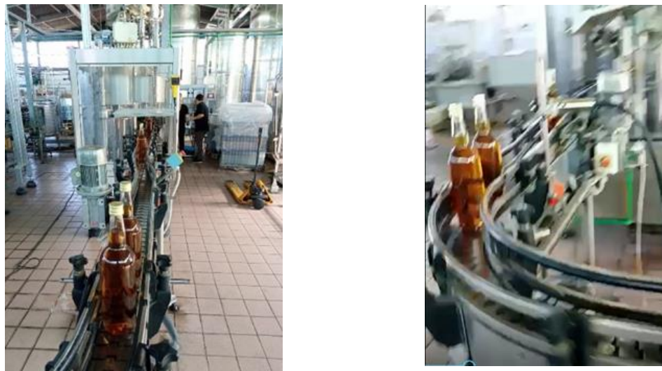
Slika 22. Horizontalni člankasti transporteri s metalnom trakom pravocrtnog gibanja (lijevo) i zakrivljenog gibanja (desno) Izvor: Osobna izrada autora (29. 8. 2022.)
