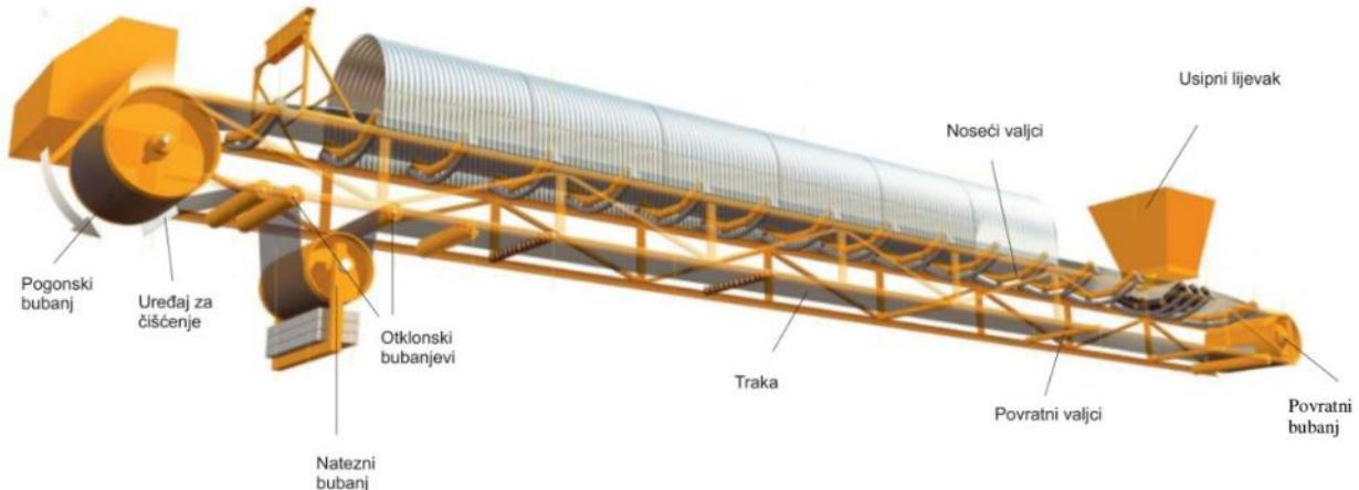
Slika 6. Osnovni elementi trakastog transporterja
