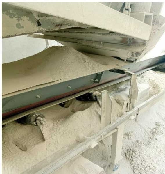
Slika 26. Transport vapna trakastim transporterom
