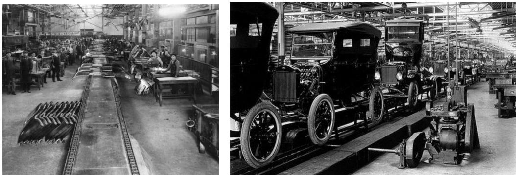
Slika 1. Montažna transportna traka Fordova automobila Model-T (lijevo i desno)
