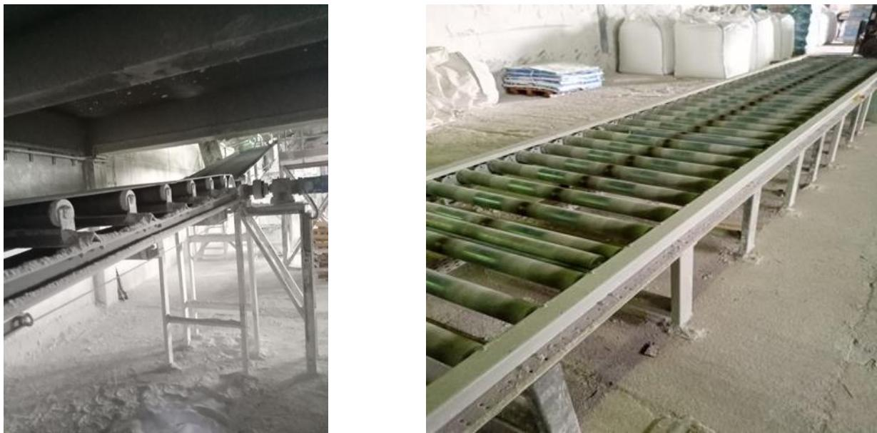
Slika 27. Trakasti transporter sa sintetičkom trakom (lijevo), valjkasti transporter (desno)
