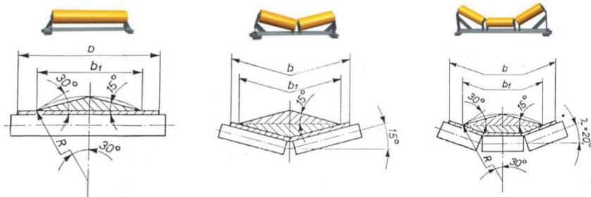
Slika 10. Presjek trake: (lijevo - ravna, u sredini - oblik V i desno - koritast s kutom nagiba  $20^0$ )
