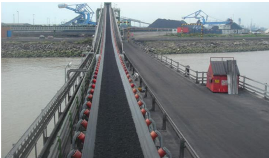
Slika 2. Suvremeni trakasti transporter ugljena u luci Immingham u Velikoj Britaniji
