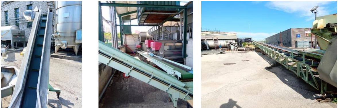
Slika 21. Trakasti transporteri u vinariji Vinoplod: za kosi transport (lijevo i u sredini), horizontalni transport (desno)
