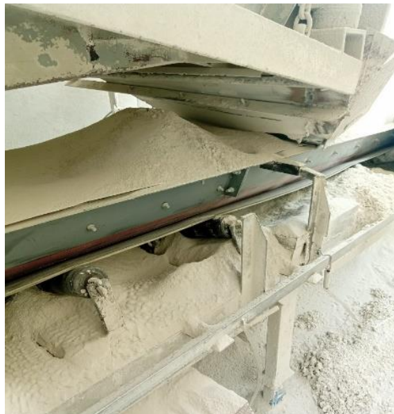
Slika 26. Transport vapna trakastim transporterom
