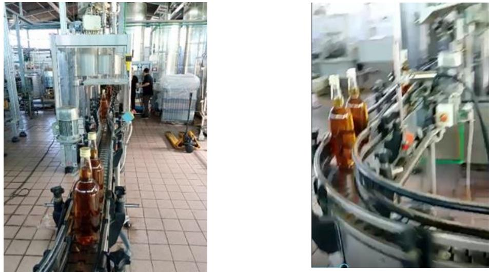
Slika 22. Horizontalni člankasti transporteri s metalnom trakom pravocrtnog gibanja (lijevo) i zakriviljenog gibanja (desno) Izvor: Osobna izrada autora (29. 8. 2022.)
