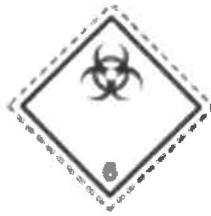
Slika 11. Listice infektivnih tvari, Izvor: Pravilnik o međunarodnom prijevozu opasnih tvari željeznicom – RID 2019
