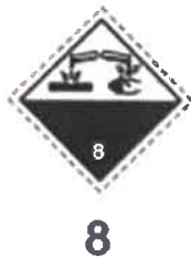
Slika 13. Listice korozivnih tvari, Izvori: Pravilnik o međunarodnom prijevozu opasnih tvari željeznicom – RID 2019.
