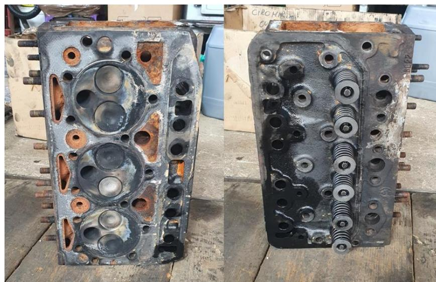
Slika 5. Primjer istrošene glave motora IMT 539, Izvor: autor
