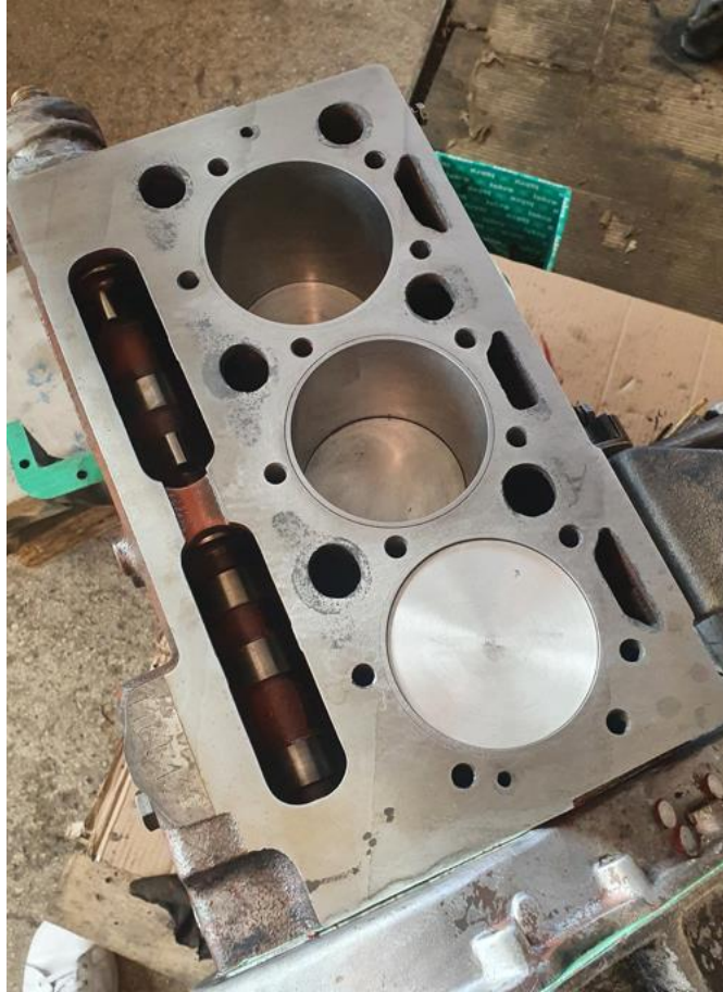
Slika 12. Blok motora sa cilindrima i bregastom osovinom, Izvor:autor
