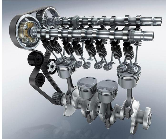
Slika 9. Bregasta osovina u glavi motora povezana zupčastim remenom, Izvor:
