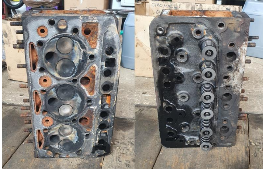
Slika 5. Primjer istrošene glave motora IMT 539, Izvor: autor
