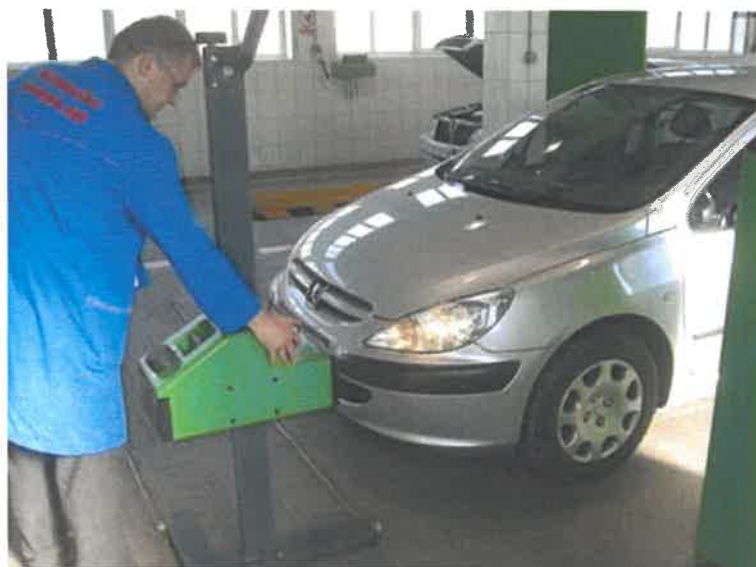
Slika 17. Ispitivanje svjetala pomoću regloskopa
