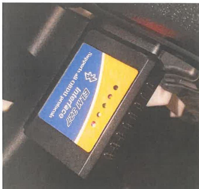
Slika 19. Priklučeni OBD uređaj na vozilo
