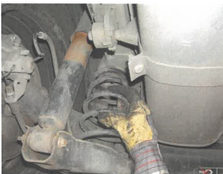
Slika 10. Provjera ispravnosti stražnje osovine i amortizera
