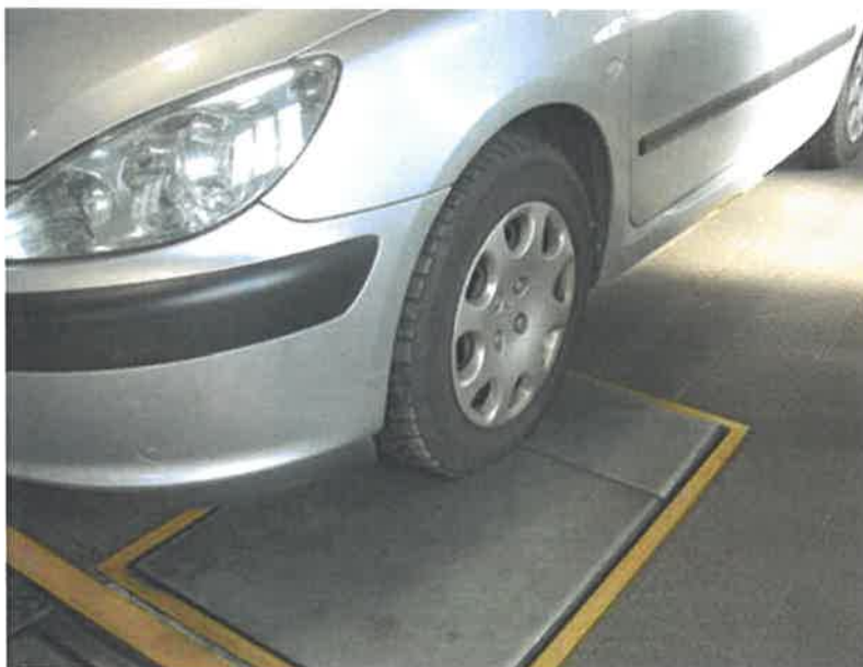
Slika 13. Provjera kontrole traga kotača
