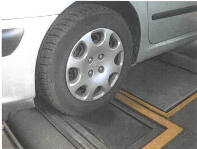
Slika 14. Ploča za testiranje stupnja prigušenija amortizera
