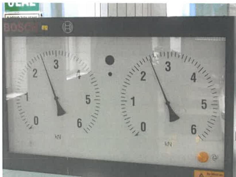
Slika 16. Analogni pokazivač kontrole kočnica
