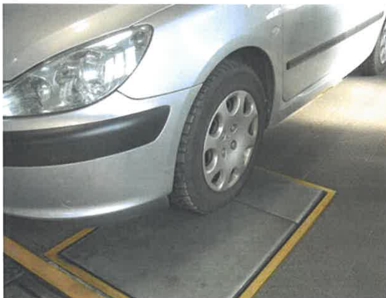
Slika 13. Provjera kontrole traga kotača
