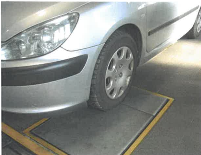
Slika 13. Provjera kontrole traga kotača
