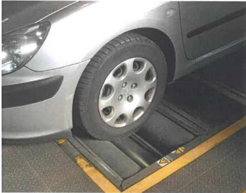
Slika 15. Valjci za ispitivanje kočnica na vozilu
