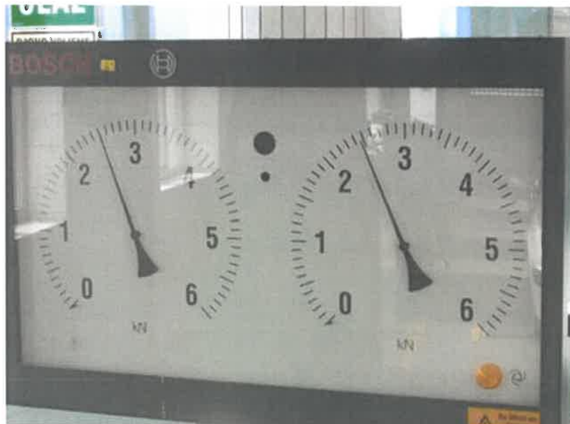
Slika 16. Analogni pokazivač kontrole kočnica
