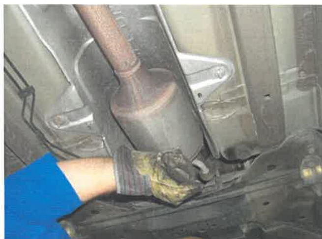
Slika 9. Udaranje rukom katalizator radi provjere njegovog stanja
