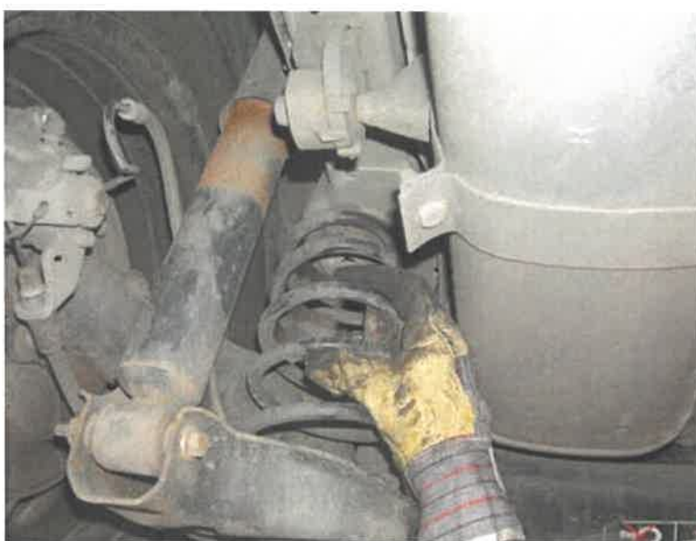
Slika 10. Provjera ispravnosti stražnje osovine i amortizera
