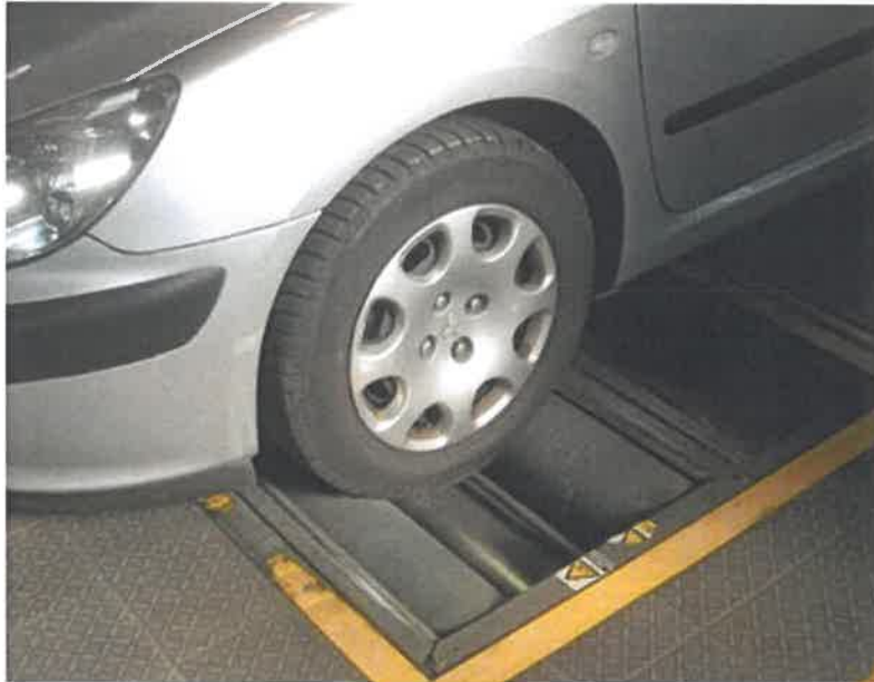
Slika 15. Valjci za ispitivanje kočnica na vozilu
