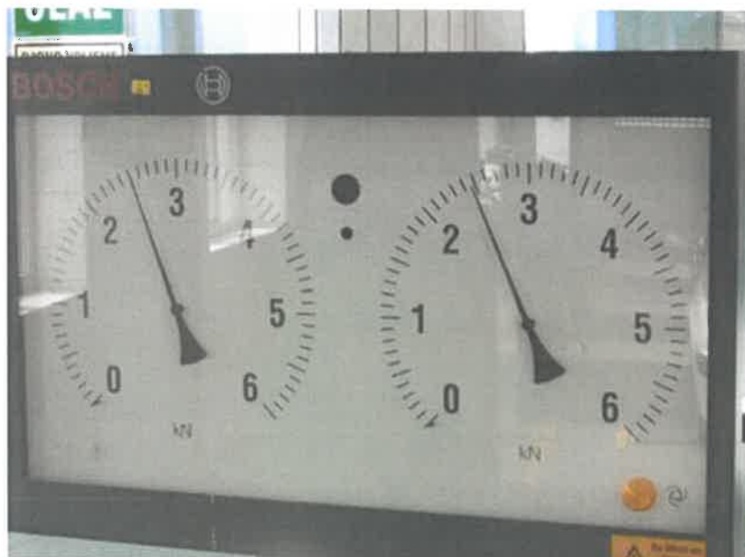
Slika 16. Analogni pokazivač kontrole kočnica
