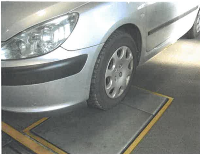
Slika 13. Provjera kontrole traga kotača
