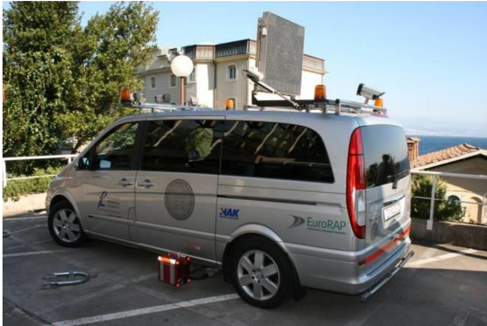
Slika 3. Vozilo za prikupljanje podataka
