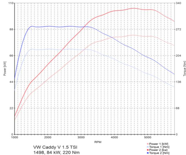
Slika 1.4. Dijagram vanjske brzinske karakteristike motora, Izvor: www.cpa-chiptuning.sg
