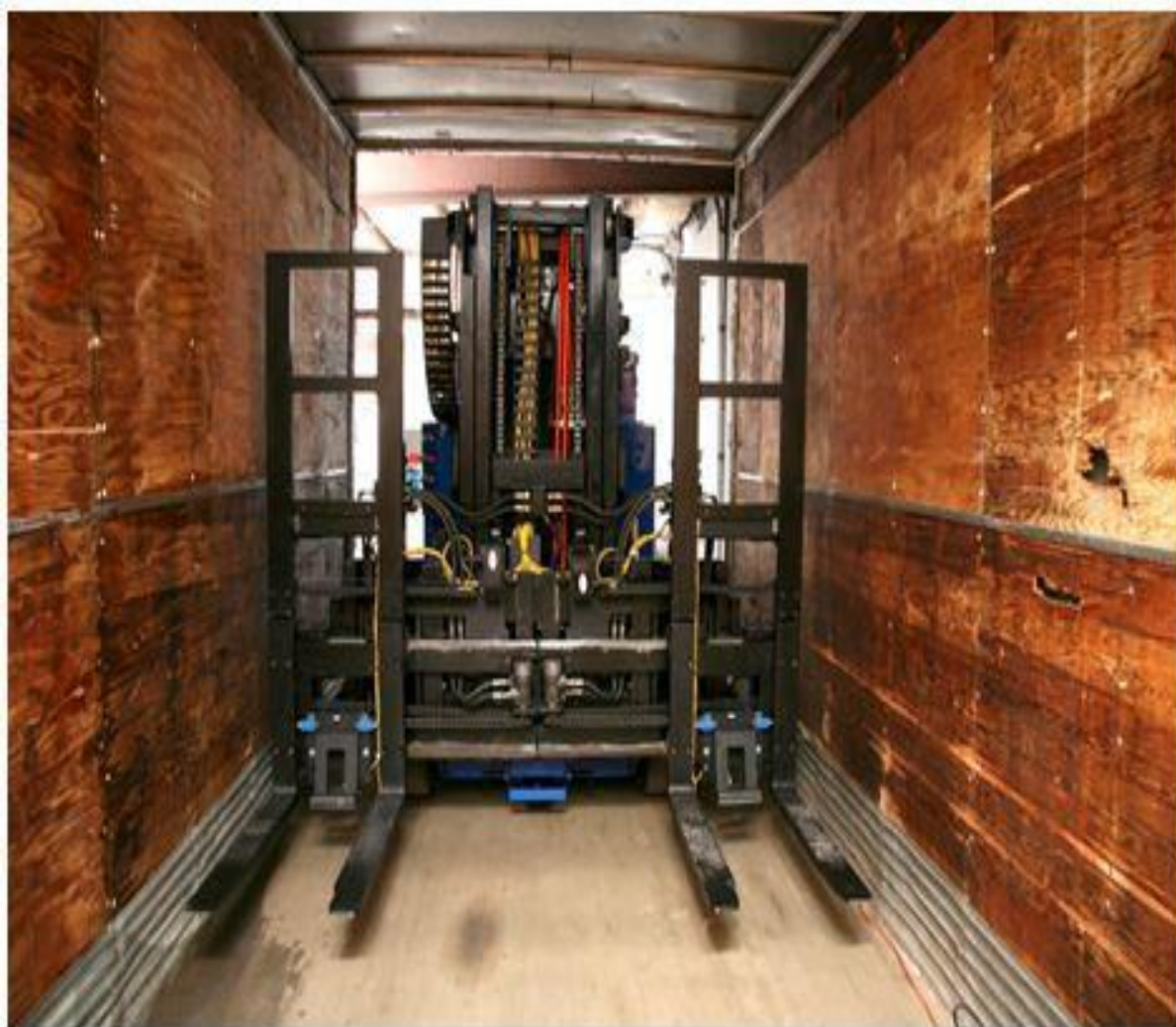
Slika 33. Izvedba automatski vođenog viličara s dvostrukim parom vilica, Izvor: Lalić, M. (2015). Tehničko-tehnološke značajke viličara i AGV vozila u unutarnjem transportu i skladištenju, završni rad, Šibenik
