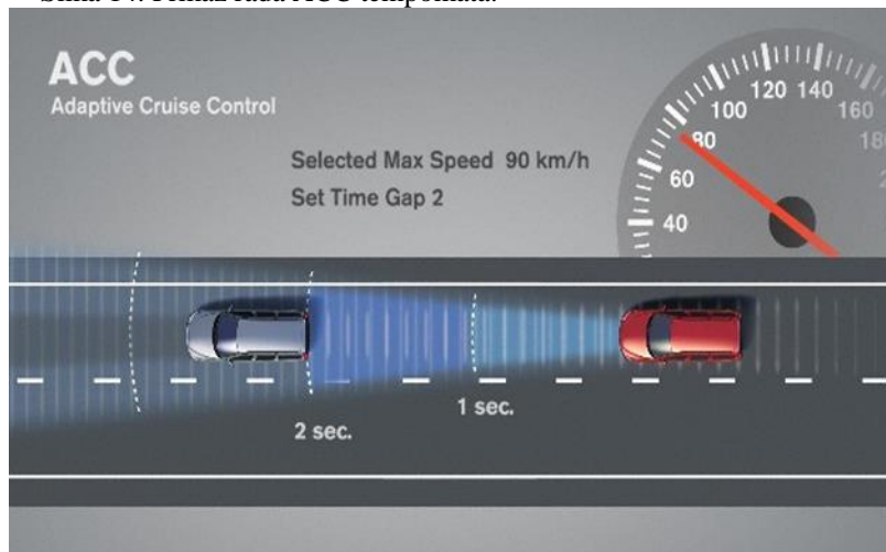
Slika 14. Prikaz rada ACC tempomata.
