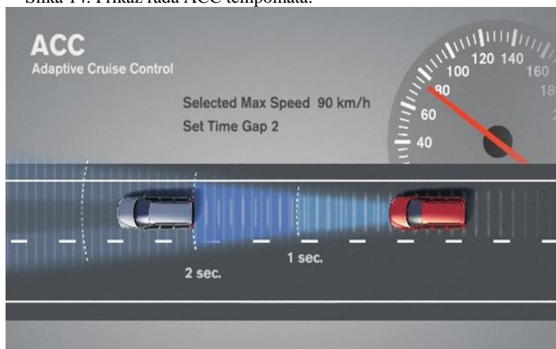
Slika 14. Prikaz rada ACC tempomata.
