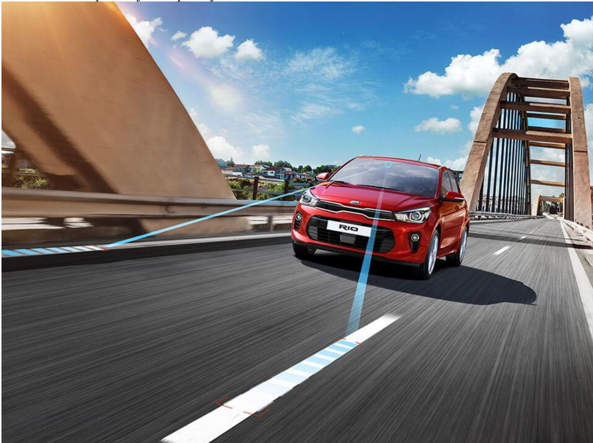
Slika 13. Sustav upozorenja za napuštanje vozne trake.
