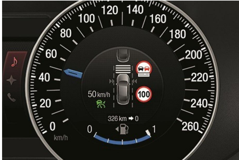
Slika 16. ISA sustav u vozilu.
