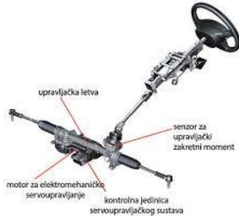
Slika 2. Prikaz upravljačkog mehanizma.
