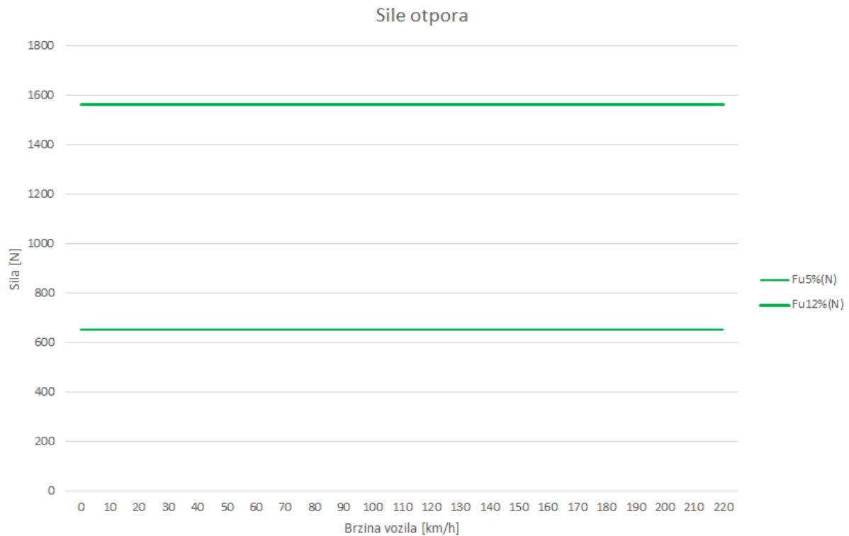
Dijagram 3. Sila otpora uspona za Mercedes B class.
