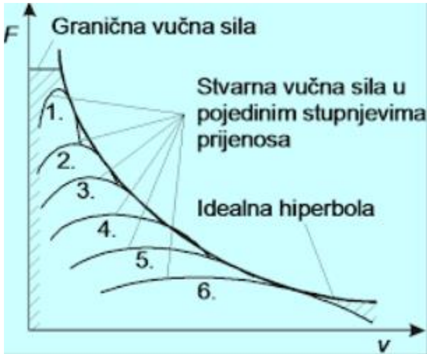
Slika 13. ovisnost vučne sile o stupnju prijenosa mjenjača.
