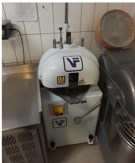
Slika 21 Preša za rezanje peciva
