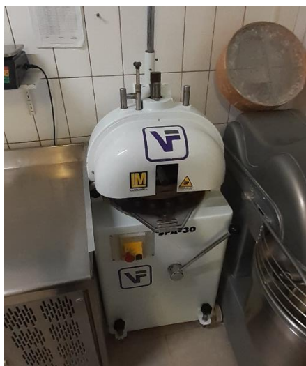
Slika 21 Preša za rezanje peciva
