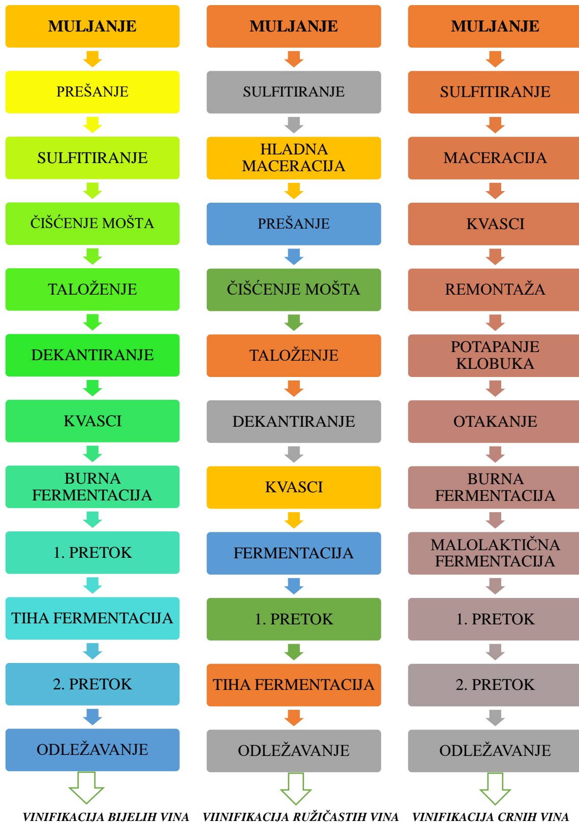
Slika 12. Proces vinifikacije bijelih, ružičastih i crnih vina.
