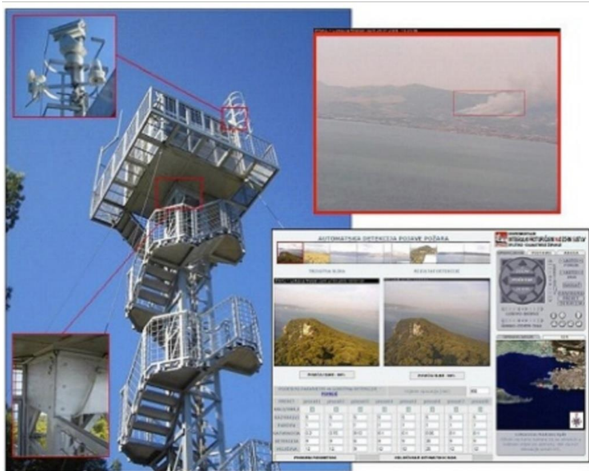
Slika 14. Motrilačka jedinica i korisničko sučelje eksperimentalne verzije sustava IPNAS postavljene na brdu Marjan u Splitu 2005.godine.
