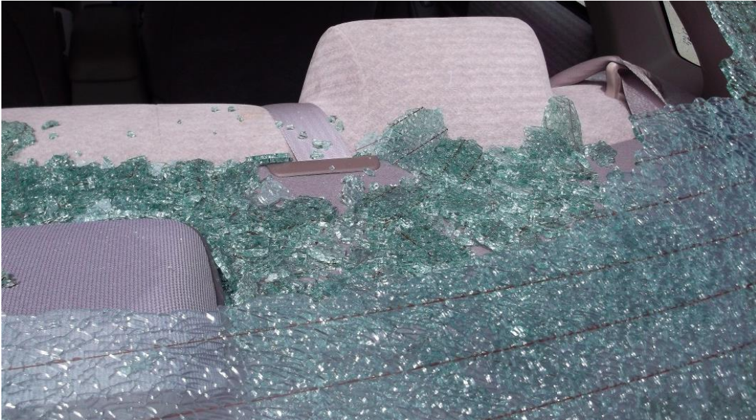
Slika 11. Puknuće jednoslojnog stakla
