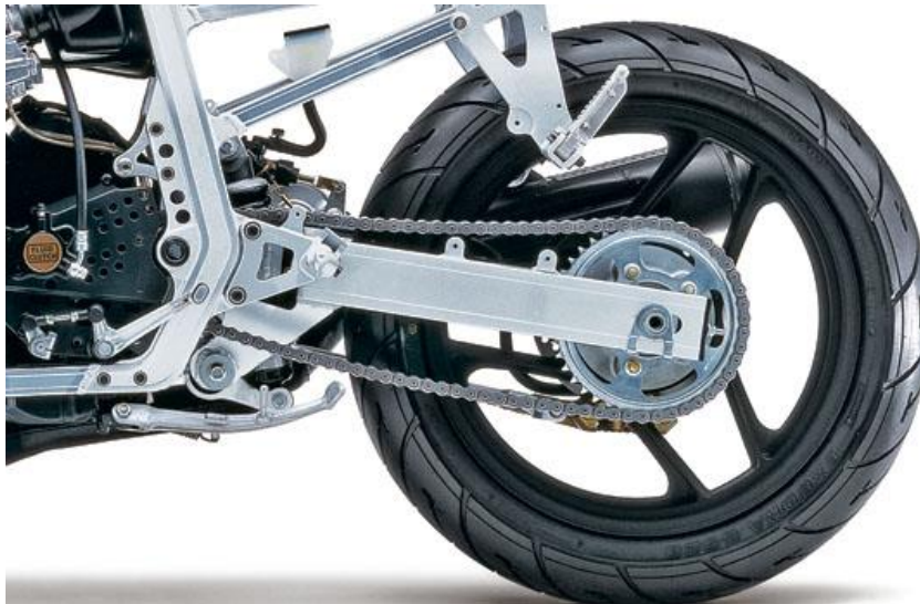
Slika 1. Stražnja vilica (Suzuki GSX-R 750 iz 1985. godine)
