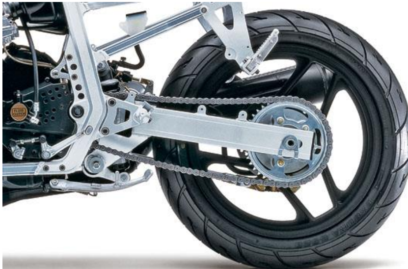
Slika 1. Stražnja vilica (Suzuki GSX-R 750 iz 1985. godine)
