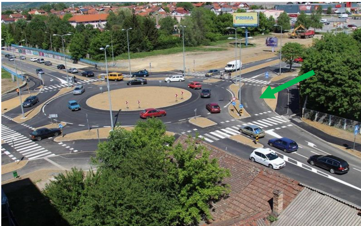
Slika 5 Traka za izdvajanje desnog skretača
