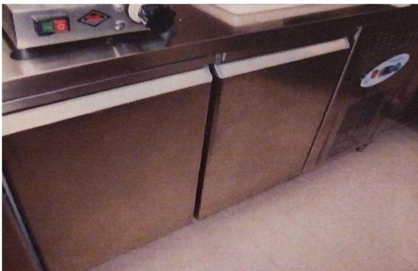
Izvana od materijala koji se mogu primjereno čistiti, održavati i dezinficirati, bez vidljivih mehaničkih oštećenja. Projektiran da omogući kontrolu i nadziranje temperature koje se brzo postižu i održavaju. Kontinuirano se prati temperatura rashladnog uređaja.
