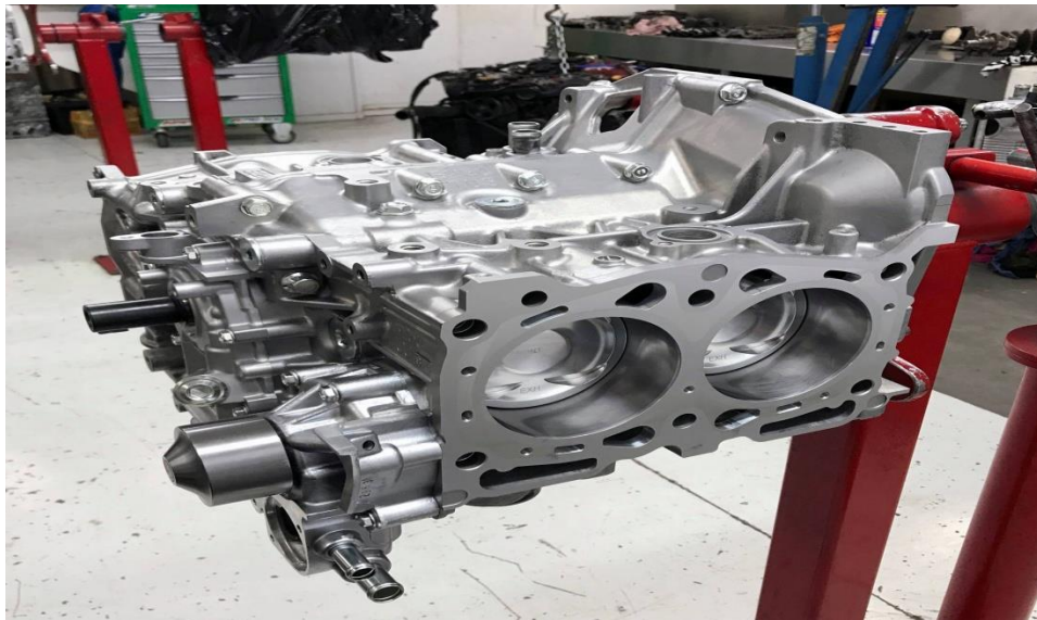
Slika 8. Zatvoreni blok motora
