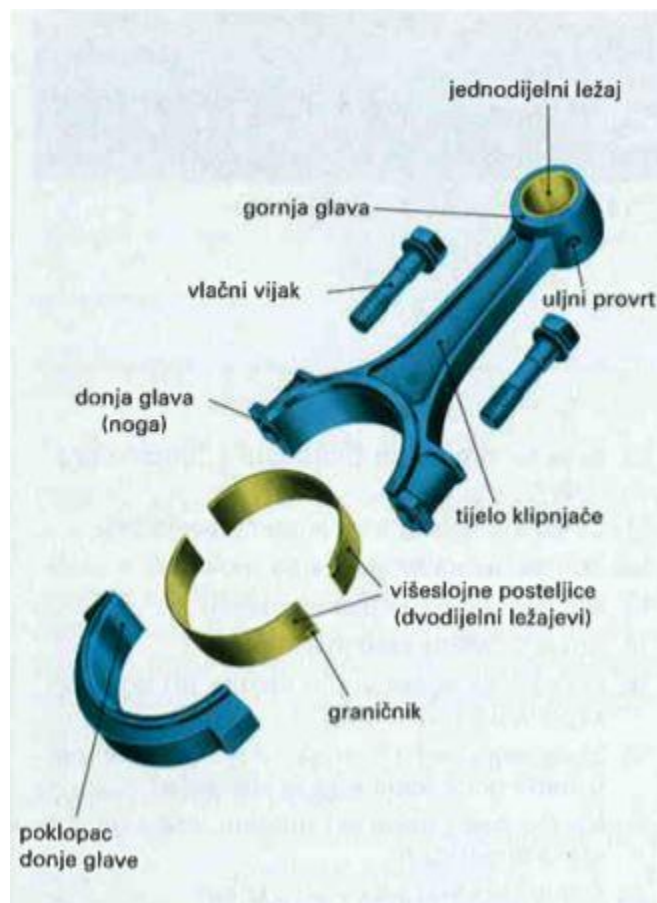
Slika 4: Dvodijelna klipnjača
