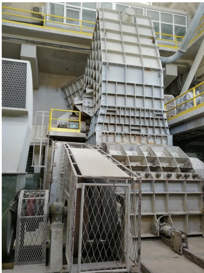
Slika 23. Drobilica komadne sirovine
