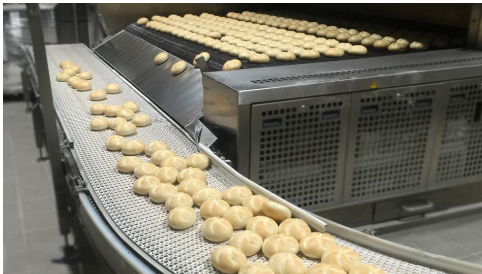
Slika 17. Primjena trakastog transportera u proizvodnji kruha
