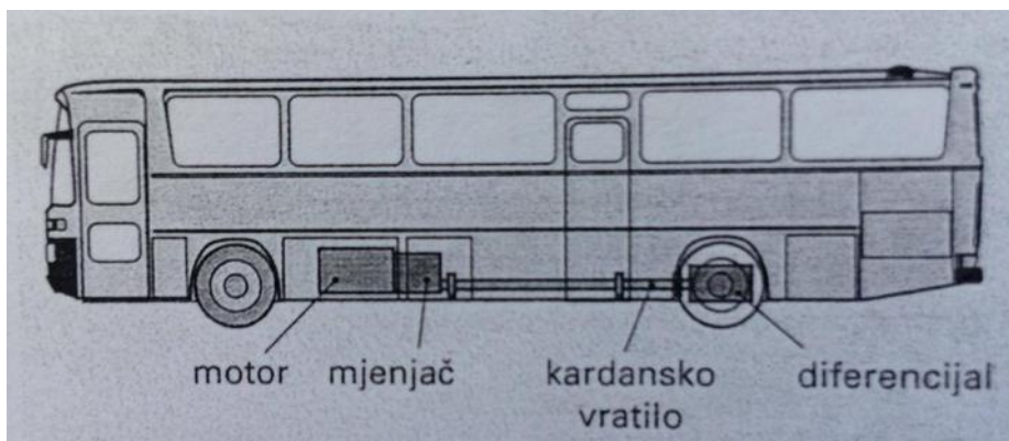
Slika 6. Motor ispod poda
