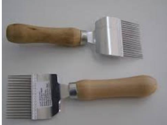
Slika 6. Vilice za otklanjanje voštanih poklopaca.
