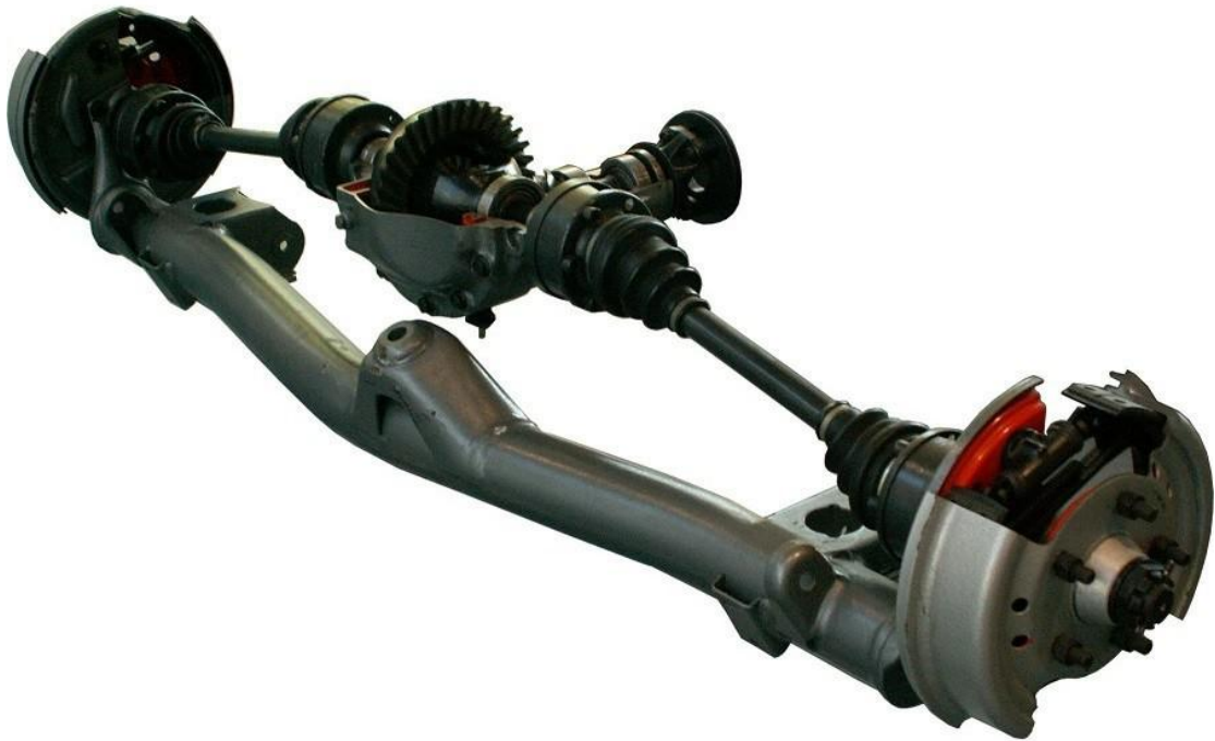
Slika 23, De Dion stražnji ovjes, Alfa rz
