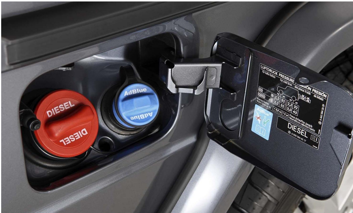
Slika 16. Prikaz izvedbe AdBlue spremnika kod novih automobila
