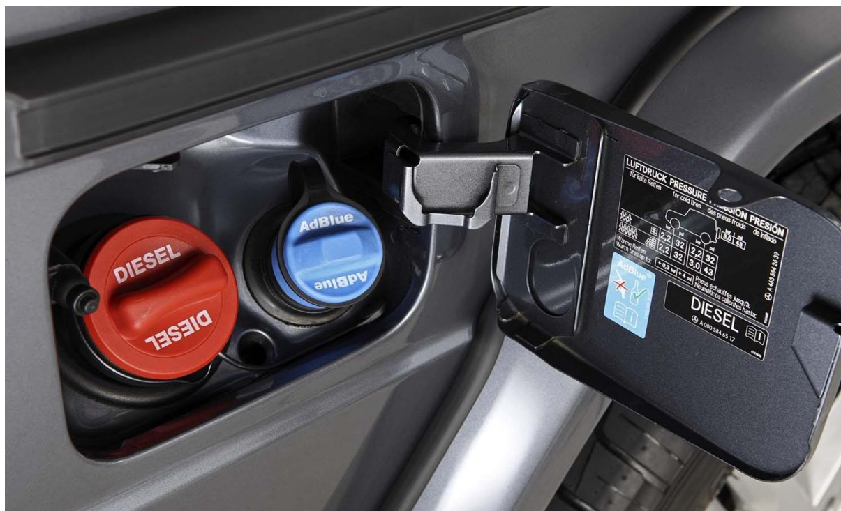
Slika 16. Prikaz izvedbe AdBlue spremnika kod novih automobila
