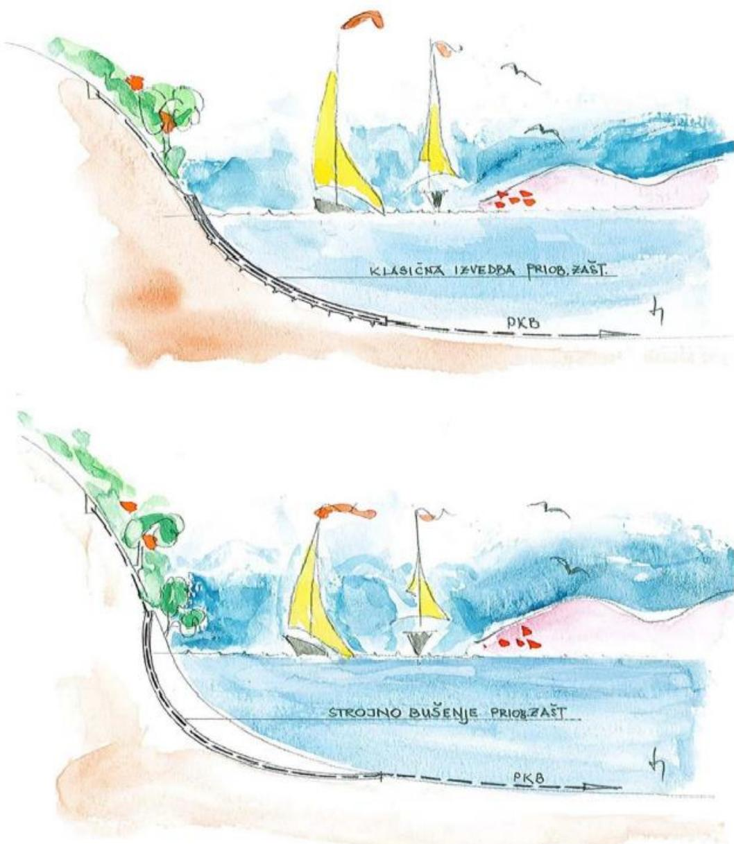
Slika 18. Klasična i strojna izvedba priobalne zaštite
