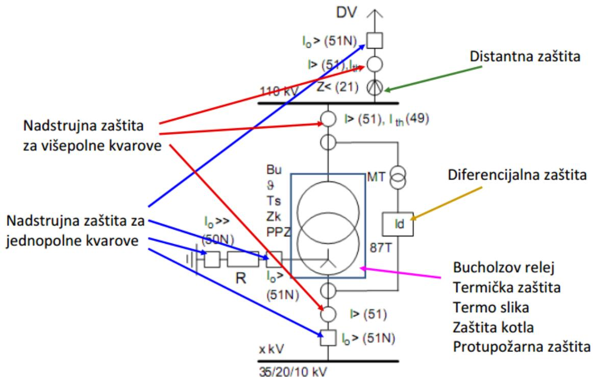
Slika 28. Zaštita transformatora (110/X kV)
