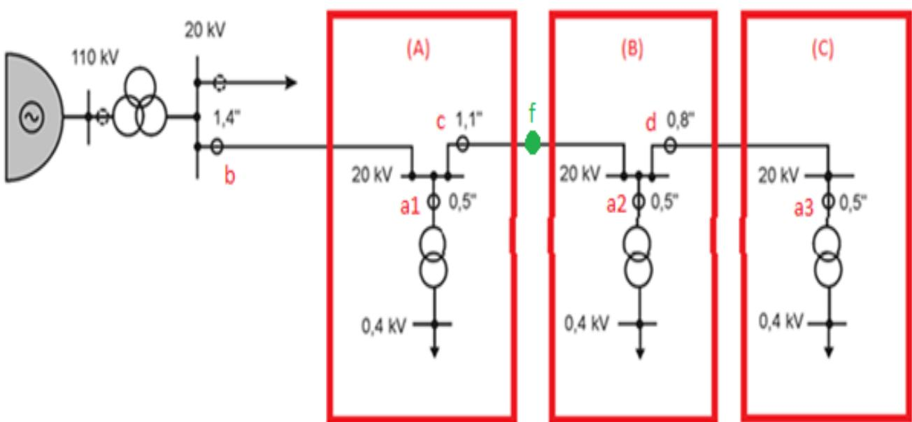
Slika 27. Jednopolni prikaz nadstrujne relejne zaštite distribucijske mreže 20kV
