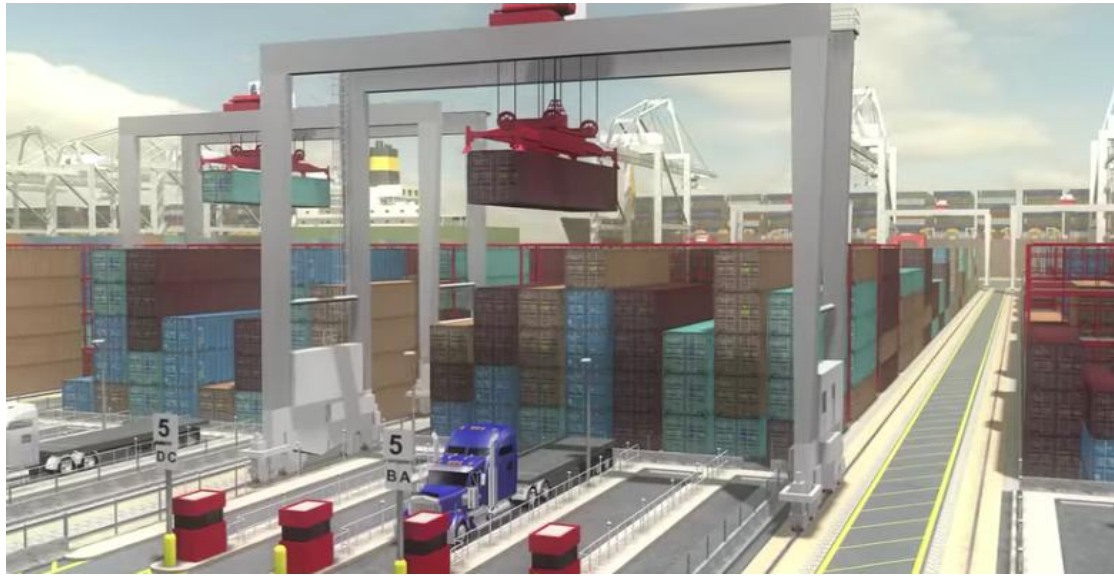
Slika 18. Automatski ukrcaj kontejnera na vozila
