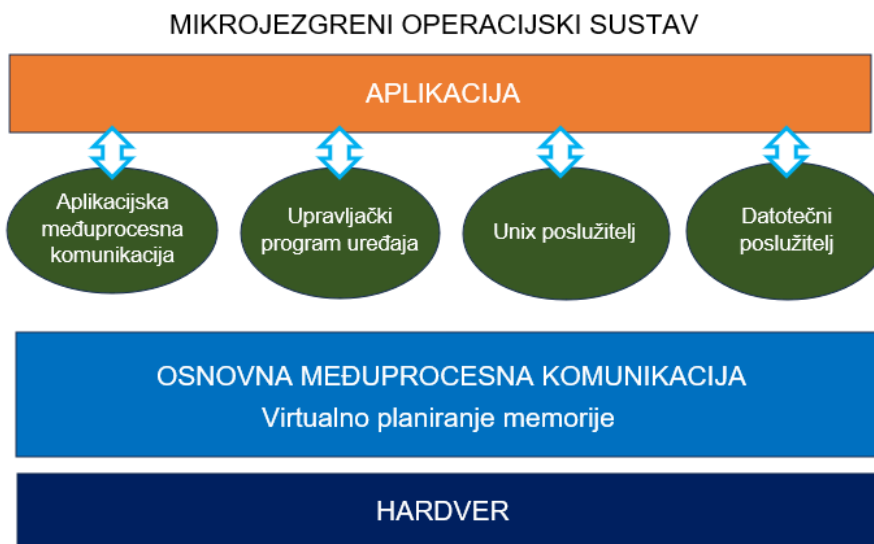
Slika 2. Mikrojezrena arhitektura, izvor: ( Microkernel In Operating System, 2024 )
