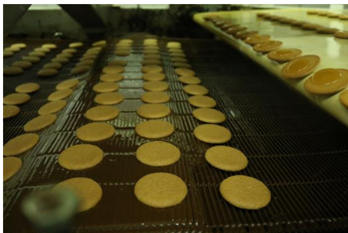
Slika 29. Trakasti transporter s žičanom trakom
