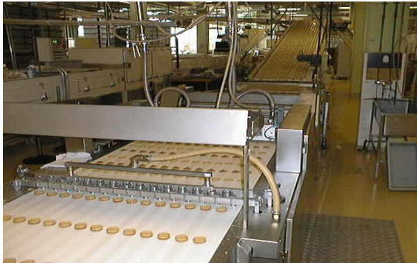
Slika 28. Trakasti transporter s čeličnom trakom
