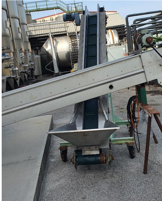
Slika 24. Kosi trakasti transporter s gumenom rebrastom trakom
