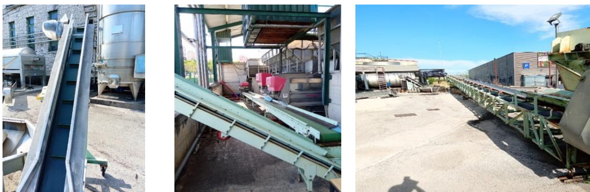
Slika 21. Trakasti transporteri u vinariji Vinoplod: za kosi transport (lijevo i u sredini), horizontalni transport (desno)
