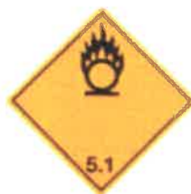
Slika 8. Listice oksidirajućih tvari, Izvor: Pravilnik o međunarodnom prijevozu opasnih tvari željeznicom – RID 2019.
