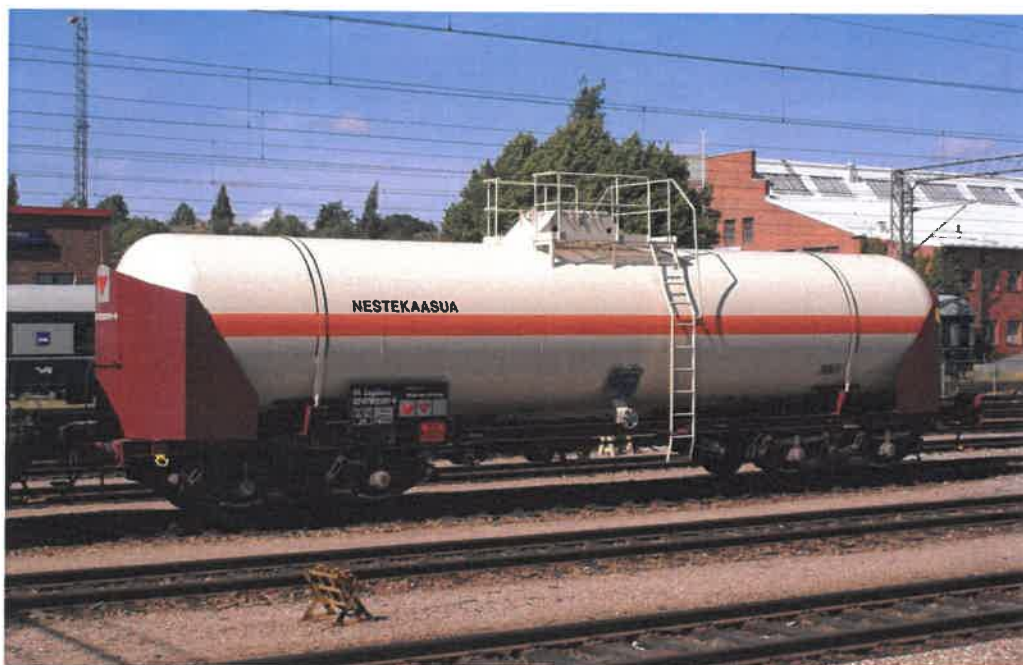
Slika 14. Vagon cisterna za prijevoz nafte, Izvor: Osobna izrada autora
