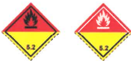
Slika 9. Listice organskih peroksida, Izvor: Pravilnik o međunarodnom prijevozu opasnih tvari željeznicom – RID 2019
