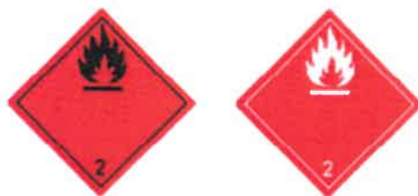
Slika 3. Listice zapaljivih plinova, Izvor: Pravilnik o međunarodnom prijevozu opasnih tvari željeznicom – RID 2019.
