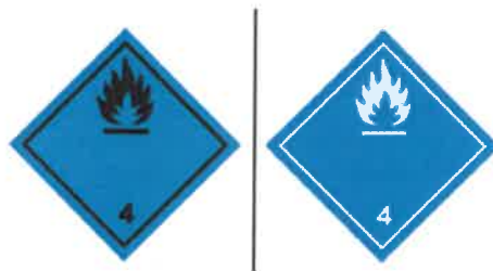
Slika 7. Tvari koje u dodiru s vodom stvaraju zapaljive plinove, Izvor: Pravilnik o međunarodnom prijevozu opasnih tvari željeznicom – RID 2019.
