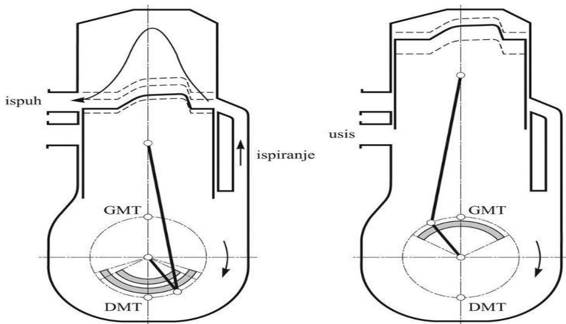
Slika 18. Princip rada dvotaktnog Otto motora, Izvor: <https://www.enciklopedija.hr/natuknica.aspx?id=16813>
