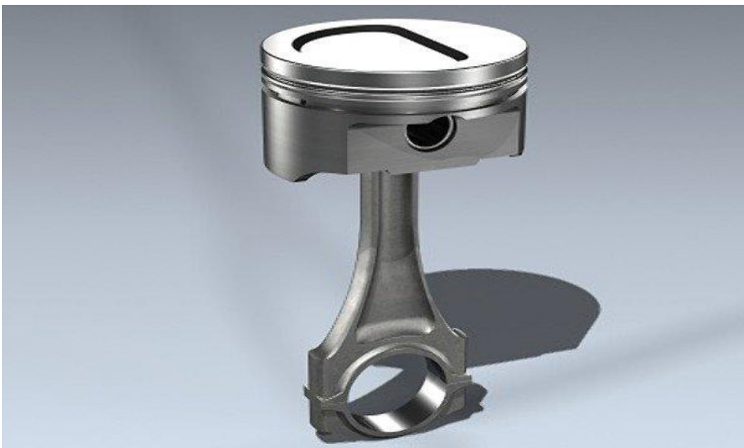
Slika 4. Klip motora, Izvor: https://automobili.narkive.hr/dz3X8pRo/to-je-zapravo-klip
