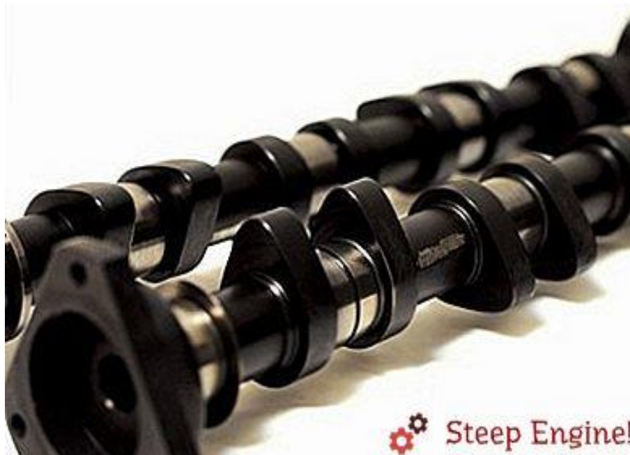
Slika 10. Bregasta osovina vozila, Izvor: https://hr.mirarh.ru/bregasta-osovina/
