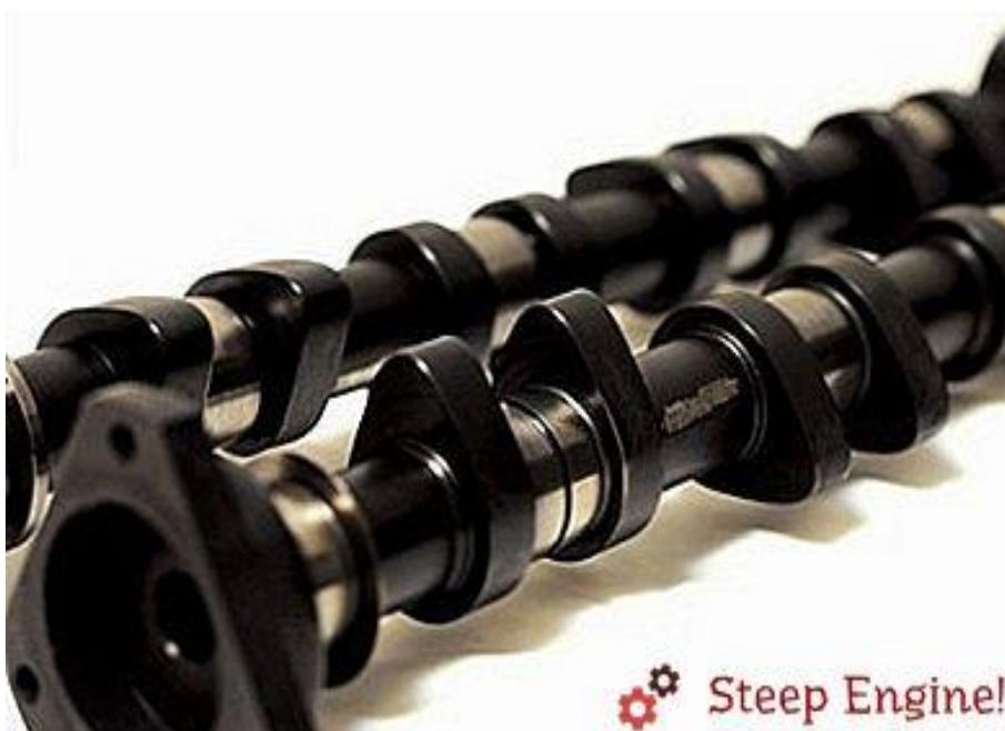
Slika 10. Bregasta osovina vozila, Izvor: <https://hr.mirarh.ru/bregasta-osovina/>
