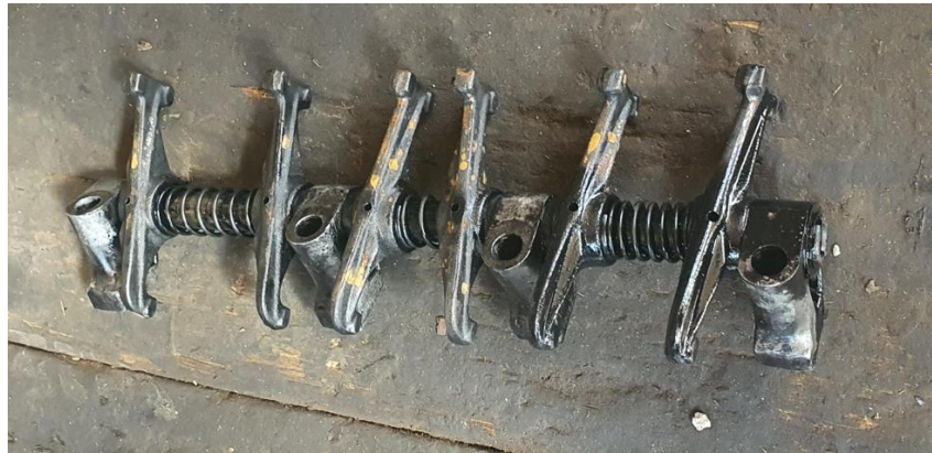
Slika 8. Klackalice motora IMT 539, Izvor: autor
