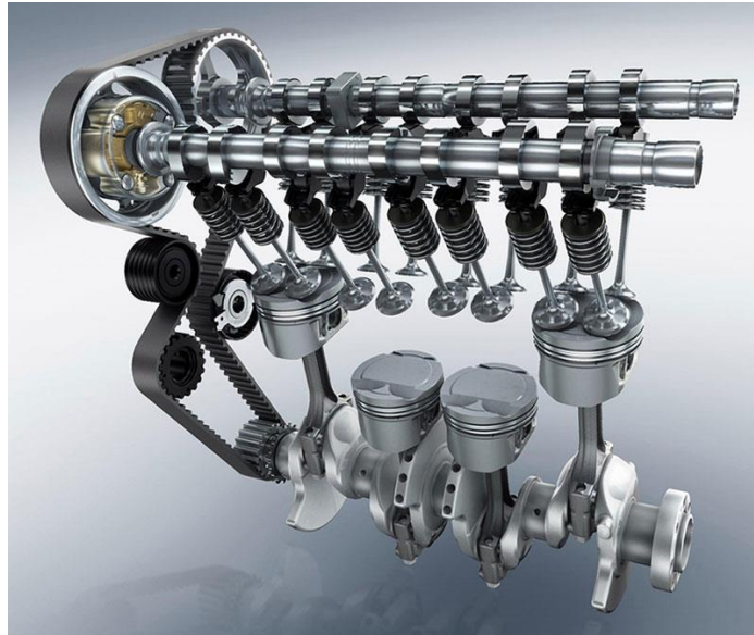
Slika 9. Bregasta osovina u glavi motora povezana zupčastim remenom, Izvor: https://postava.mxstroy.ru/
